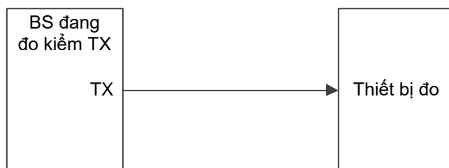
Hình C.1 – Thiết lập hệ thống đo công suất ra của trạm gốc, công suất ra động, chất lượng tín hiệu phát, lỗi tần số, EVM, công suất DL RS, phát xạ không mong muốn
